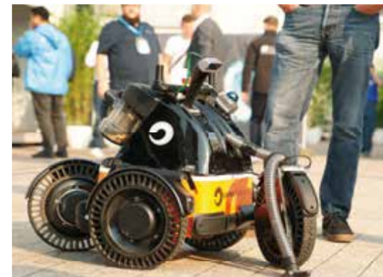
▲ Roboter „Butty“ von der Firma Capra Robotics räumt in Köln mit Zigarettenstummel auf – dank künstlicher Intelligenz auch völlig autonom.
